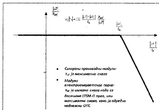
$P_{ref}$  је референтна активна снага на коју се односи  $\Delta P$ .  $\Delta P$  је промена излазне активне снаге производног модула.  $f_n$  је називна фреквенција (50 Hz) у мрежи, а  $\Delta f$  одступање фреквенције у мрежи. На надфреквенцијама при којима је  $\Delta f$  изнад  $\Delta f_1$ , производни модул мора да осигура смањење излазне активне снаге у складу са статизмом  $S_2$ .
